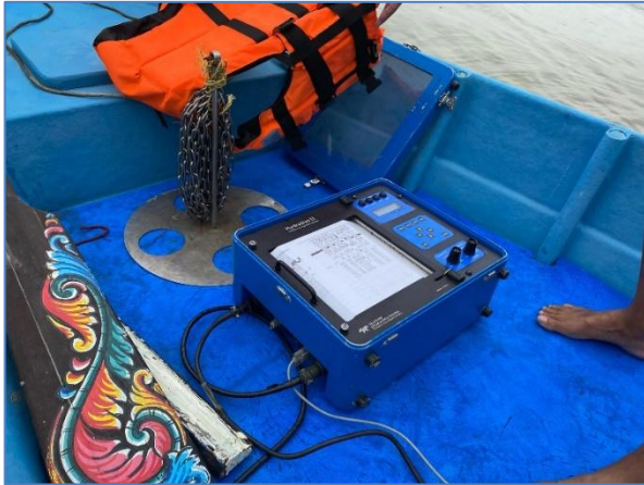
รูปที่ 3.3.5-2 เครื่อง Echo Sounder ยี่ห้อ TELEDYNE ODOM HYDROGRAPHIC รุ่น Hydrotrac II
