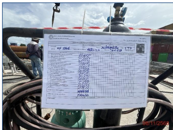
รูปที่ 2.2.2-4 สติ๊กเกอร์ติดเครื่องจักรที่ผ่านการตรวจสอบแล้ว และตัวอย่างแบบบันทึกการตรวจสอบเครื่องจักรประจำวัน
