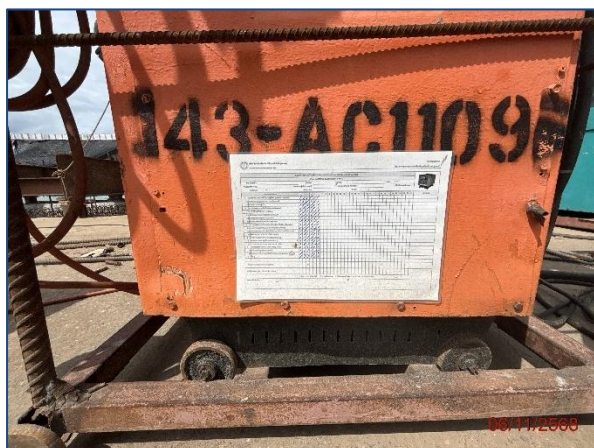
รูปที่ 2.2.2-4 สติ๊กเกอร์ติดเครื่องจักรที่ผ่านการตรวจสอบแล้ว และตัวอย่างแบบบันทึกการตรวจสอบเครื่องจักรประจำวัน
