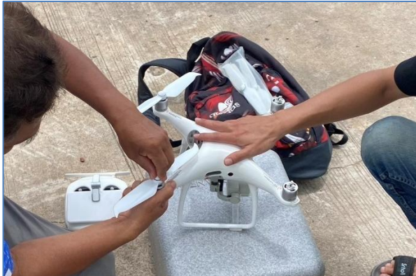
รูปที่ 3.3.1-8 อุปกรณ์ โดรน (Drone) DJI รุ่น Phantom 4
