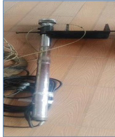
รูปที่ 3.3.5-3 หัว Transducer ความถี่ 200 KHz
