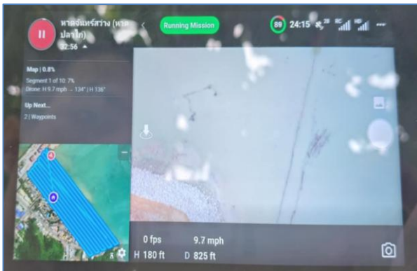
รูปที่ 3.3.1-9 จอแสดงภาพการวางแผนการบินถ่ายภาพในพื้นที่ชายฝั่งบริเวณอ่าวบ้านหน้าหลา บนรีโมทบังคับ อุปกรณ์ โดรน (Drone) DJI รุ่น Phantom 4
